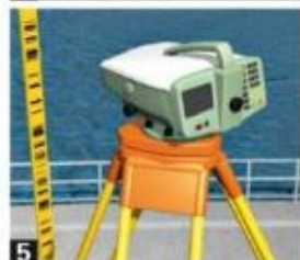
Nivelliergerät zum geodätischen Vermessen von Höhen- unterschieden und damit der Verformung der Staumauer
