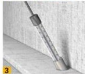
Thermometer zur Messung der Wasser- und der Betontemperatur
