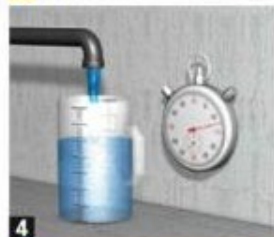
Stoppuhr und Massbecher zum Messen der Sickerwassermenge
