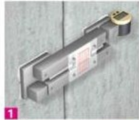
Mikrometer zum Messen der Breite von Fugen und Rissen (es gibt keine Staumauer ohne Risse)
