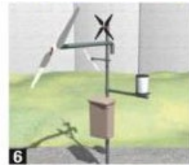
Pluviograf zum Messen und Aufzeichnen der Regenmenge
